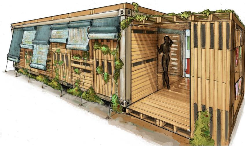
L'objectif de ce projet a été de réaliser un abri d'urgence, en ayant comme base un conteneur et des palettes en bois (objet facile à trouver, et fréquemment utilisée à des fins industrielles.) Le conteneur est tout d'abord installé sur des pneus, ce qui favorise la ventilation naturelle et permet de limiter les remontées d'humidité.
