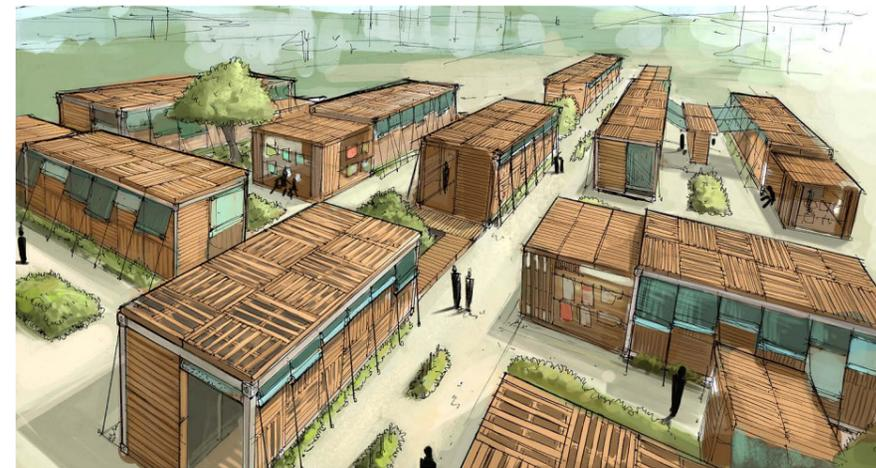
la terre. Ainsi, cette composition servira d'isolant thermique, tout en protégeant l'habitant des intempéries. En façade, l'association d'une toile de paillage (brise soleil) et d'un papier bulle imperméable, tendues par des câbles fourniraient un confort supplémentaire. Enfin à l'extérieur un espace cuisine et un potager sont prévus pour deux habitats.
